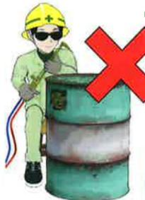
設備の工事や修理の場合、設備内部のガスを水か窒素で置換して行わなければなりません。
